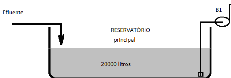
Figura 1 - reservatório para recepção e tratamento químico do efluente
